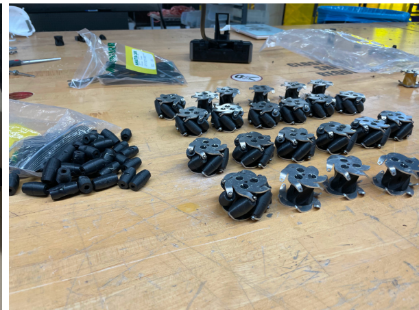
(d) Rollers and Assembled Wheels
